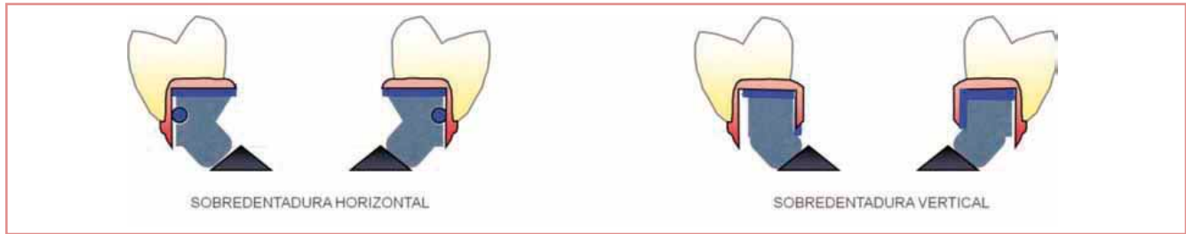
Figura 1. Esquema donde se demuestra la diferencia de conexión de la estructura secundaria sobre la primaria dependiendo de si la sobredentadura es de inserción vertical u horizontal.
